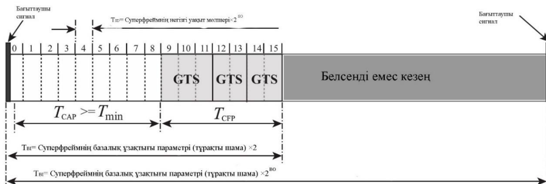
1.3-сурет – IEEE 802.15.4 стандартындағы суперфрейм құрылымы.
