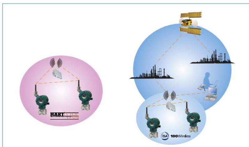
3.2-сурет – Өндірістегі сымсыз өрістік желілердің өзара үйлесімді жұмысы
